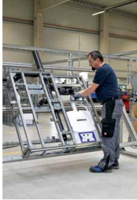
Industrielle Vorfertigung: Tragsystem inklusive aller Montageelemente plus Teilverrohrung.
