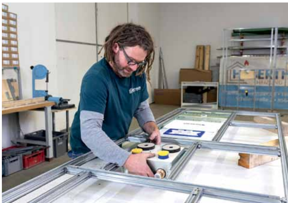
Die handwerkliche Vorfertigung: Das Tragsystem wird auf dem Arbeitstisch zusammengefügt.
