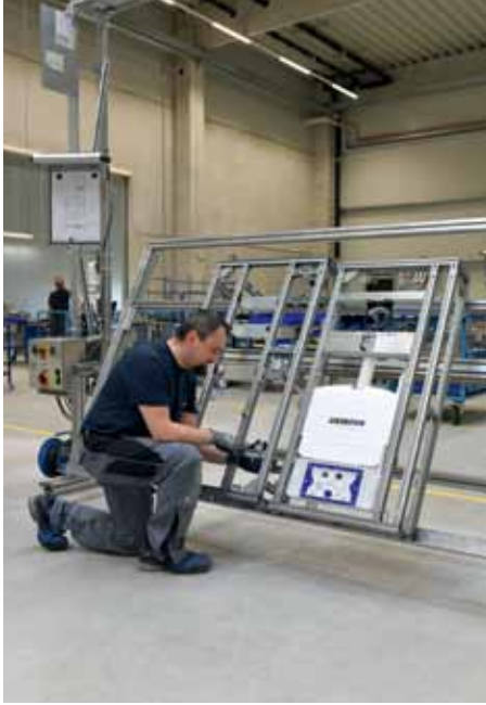
Industrielle Vorfertigung: Tragsystem inklusive aller Montageelemente, aber ohne Verrohrung.
