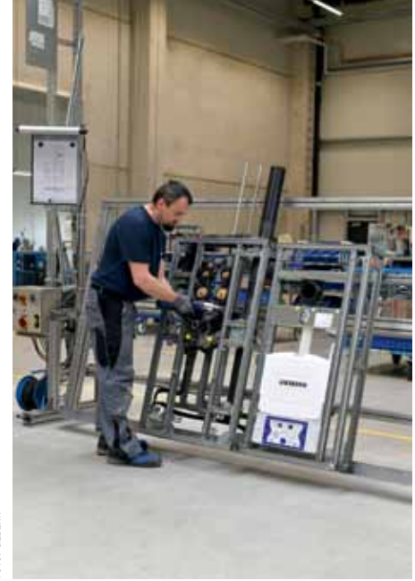
Industrielle Vorfertigung: Tragsystem mit allen Montageelementen und Rohrleitungen – das komplett industriell vorgefertigte System.
