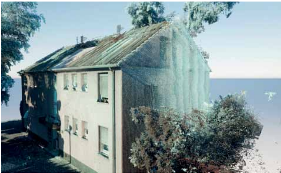
Jedes serielle Sanierungsprojekt startet mit einem millimetergenauen 3D-Scan.
